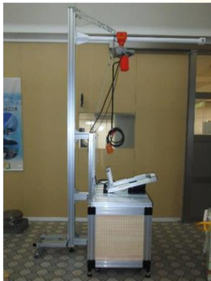
カスタマイズした作業台(上図) (電動チェーンブロックと治具台を装備)
